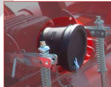
PDF POSTERIORE REAR PTO PDF ARRIÈRE HINTERE ZAPFWELLE TOMA DE FUERZA TRASERA STANDARD R17R - R25R OPTIONAL R12R
